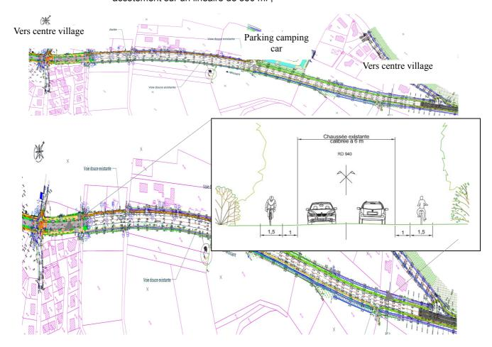
Aménagement du carrefour existant avec mise en place d'un plateau surélevé sur 80 ml couplé à une rectifications des carrefours afin de supprimer les mouvements trop tangentiels qui facilitent les vitesses élevées. Le plateau permettra de marquer l'entrée de la commune pour les usagers motorisés et également facilitera la traversée des cyclistes qui chemineront ensuite sur un axe bidirectionnel à l'Est de la RD 940
